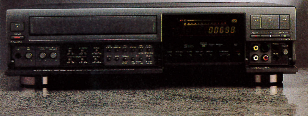
Due sportelli a ribalta nascondono la quasi totalità dei comandi; si nota il commutatore destinato a «forzare» la commutazione in 16/9 in mancanza dell'apposito segnale di commutazione.
